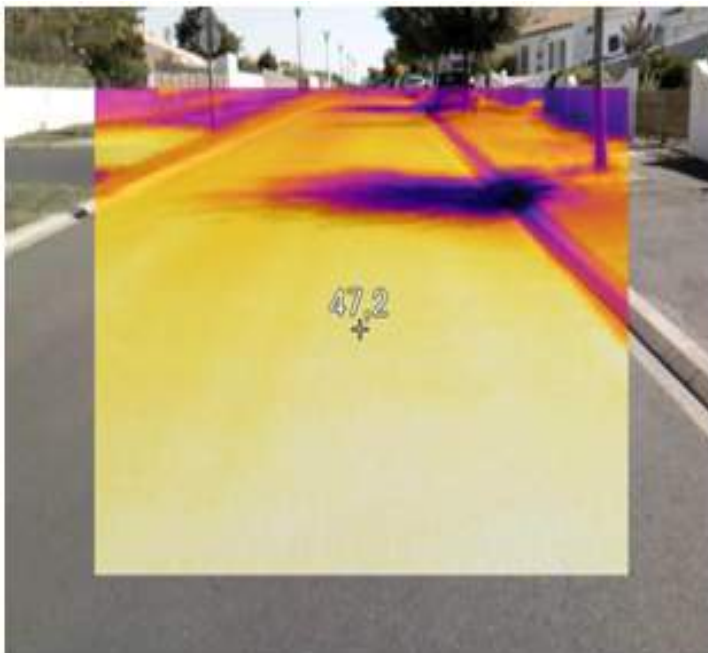
Figure 16 : Mesure de la température d'une rue bétonnée lors d'une journée de haute chaleur
